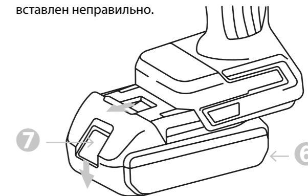
Рисунок 2.1.1. снятие аккумуляторного блока
