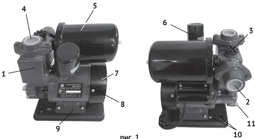
**1** – корпус насоса; **2** – входное отверстие; **3** – пробка заливной горловины; **4** – выходное отверстие; **5** – гидроаккумулятор; **6** – реле давления; **7** – крышка крыльчатки двигателя; **8** – двигатель; **9** – основание; **10** – крепёжные отверстия; **11** – отверстие для слива воды.
